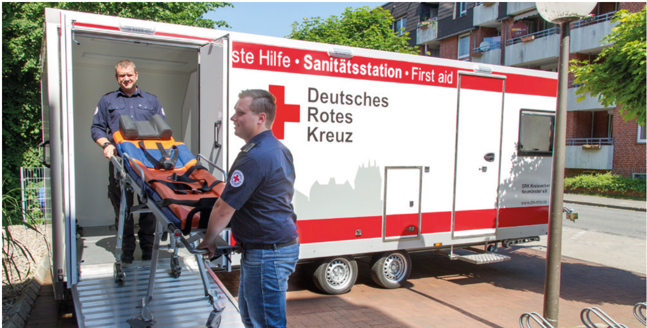
Über eine abnehmbare Rampe können hilfsbedürftige Personen direkt in den Behandlungsraum geschoben werden.
